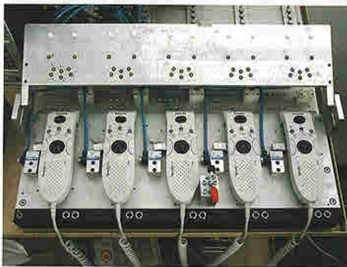
▲ Testování životnosti ovládacích prvků USB mikrofonu SpeechMike pro přímé diktování do PC
